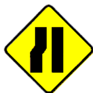
Estreitamento de pista à esquerda.
