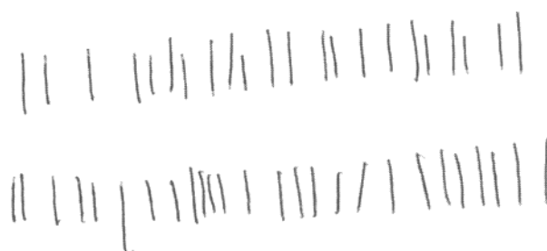
Irregularidades no alinhamento dos palos.
